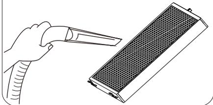
2.微静电过滤器污垢严重时可以将其浸泡在加入少量洗洁精的温水中2到3分钟。（推荐使用爱优特专用清洗剂）
