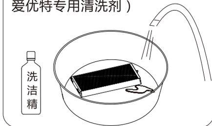
3.将浸泡后的微静电过滤器拿到自来水下冲洗，配合软毛刷直至清洗干净。
