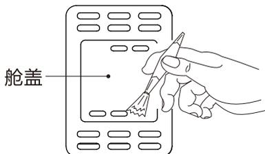
2. 取下舱盖,用棉棒擦拭传感器图示位置的内部透镜，棉棒可蘸少量清水，湿润即可，切勿使用酒精。传感器可每月进行一次清洁。
