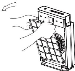
3. 双手按住微静电过滤器上端两个卡扣，将其取下。
