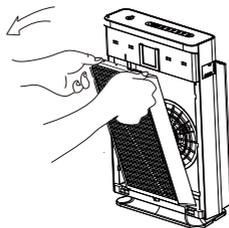
4. 拆掉M8甲醛过滤器(选配)的包装，并将其装回净化器原位置。
