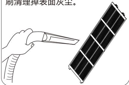
2.用清水冲洗后，晾干使用。污垢严重时可以用软毛刷配合中性洗涤液清洗，充分晾干后使用。
