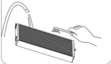
4.将洗净过滤器上的水甩干，放置在通风良好的地方，待其干透后再重新放入机器。参照16页。
